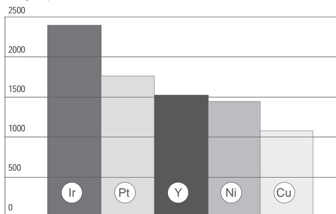
Сравнение значений показателя температуры плавления для каждого из металлов, используемых в электродах свечей зажигания. / Comparison of melting temperature values for each metal used in spark plug electrodes.
