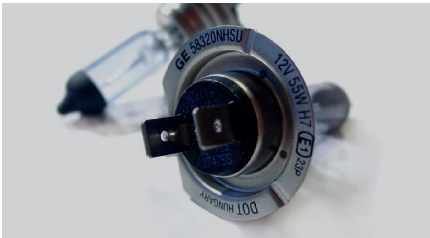
Маркировка галогеновой автолампы
